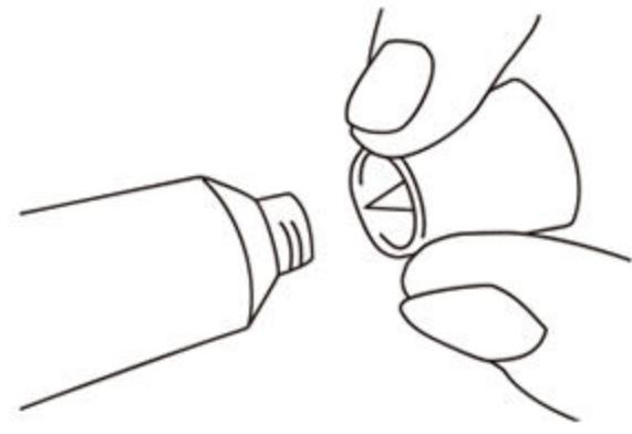
キャップ上部の突起部でチューブの出し口(アルミシール)にしっかり穴をあけてお使いください。
